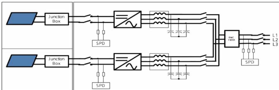
1. 2 MPP Tracker : 250kW 개별운전 가능하여 시스템 효율과 가동율 상승
